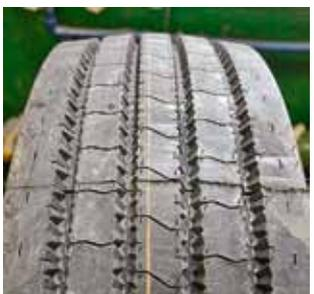
NF 201 – покрышки устанавливаемые на рулевую ось
