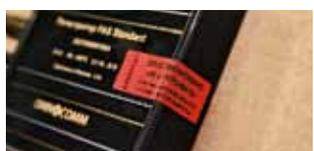
**Пломбирование электронного блока производится специальной клейкой лентой**
