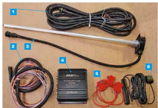
**1 и 2 – соединительные кабели; 3 – Датчик уровня топлива LLS в баке; 4 – Электронный блок FAS компании Omnicom; 5 – предохранители; 6 – антенна GPS.**
