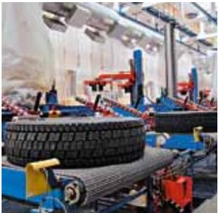
Вышедшие из вулканизаторов готовые шины охлаждаются на специальном ленточном конвейере
